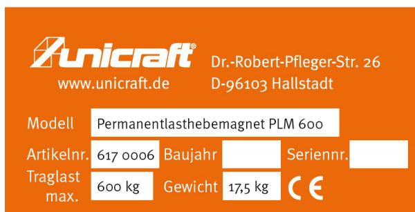
Obr. 2: Typový štítek PLM 600
