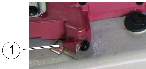
Obr. 5-8: Vyrovnání ramene pily
