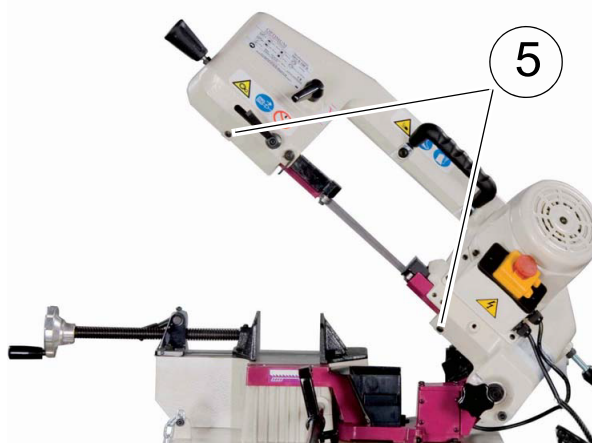
Obr. 4-9: Montáž pilového pásu - 3
