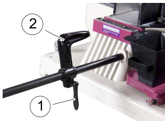
Obr. 5-14: Upnutí materiálu a doraz materiálu
