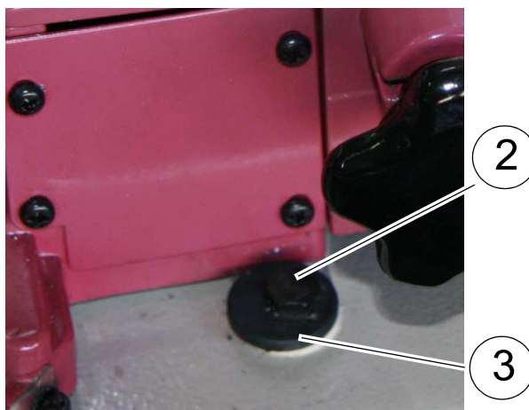
Obr. 5-9: Vyrovnání ramene pily
