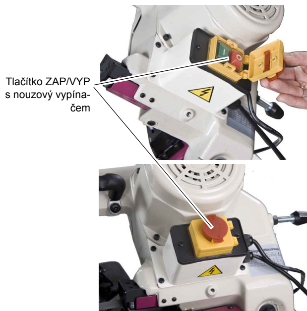
Obr. 1-1: Tlačítko ZAP/VYP s nouzový vypínačem
