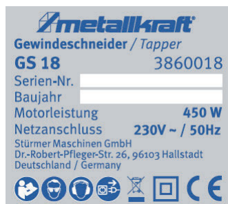
Obr. 2: Typový štítek a označení CE
