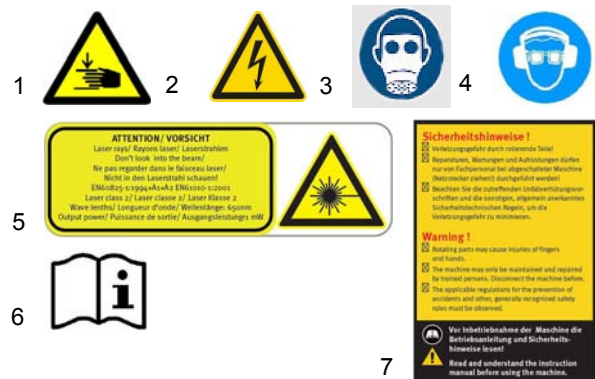
Obr. 1: Výstražné štítky 1 Varování před nebezpečím | 2 Varování před nebezpečným elektrickým napětím | 3 Použijte ochrannou roušku | 4 Použijte ochranná sluchátka | 5 Použijte ochranné brýle | 5 Varování před laserovým paprskem | 6 Přečtěte si návod k obsluze | 7 Výstražný štítek
