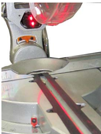
Obr. 4: Laser pro vyznačení linie řezu
