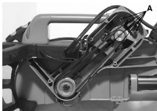
Obr. 18: Povolení šroubů motoru
